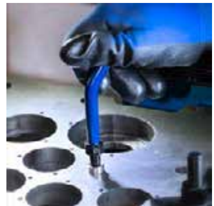
4. Vorgang Verschrauben des Spulen-Einsatzes mit dem entsprechenden Werkzeug
