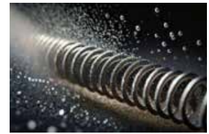
Operazione di sabbiatura con sfere di vetro (pallinatura)
