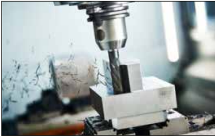
Fresatura di spallamenti
